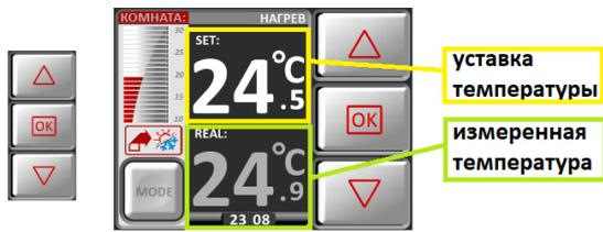
Рисунок 1 Блок кнопок настройки.
